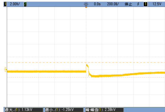
输出端电压波形(差模 1.13KV)
